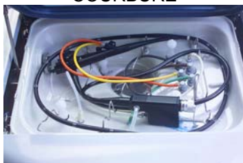
MAUVAIS RAYON DE COURBURE
