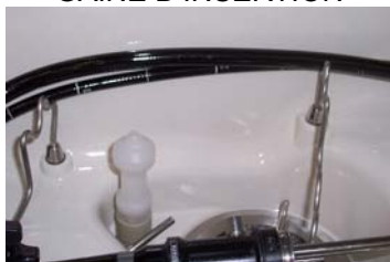
MAUVAIS DEGAGEMENT DE LA GAINE D'INSERTION
