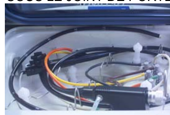
GAINE ENDOSCOPE ECRASE SOUS LE JOINT DE PORTE
